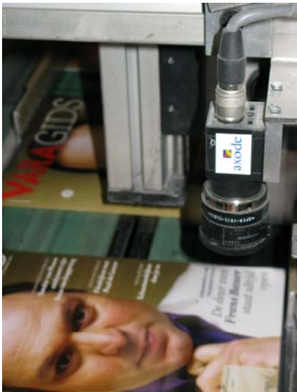
Camera's controleren volautomatisch de leesbaarheid van de inkjet adressering bij hoogvolume printen.
